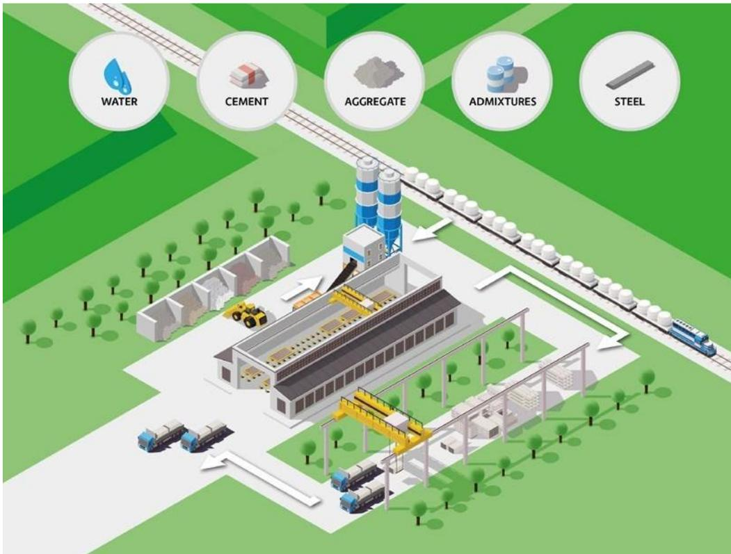
Schema der Herstellung der vorgefertigten Filigrandecken durch Pekabex BET S.A.
