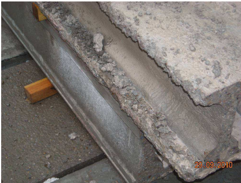
Fot. 1 - Wygląd powierzchni bocznej płyty ciętej wzdłuż metodą „na mokro”
