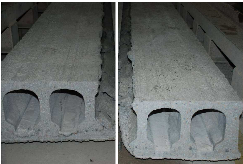
Fot. 4, Fot.5 - Wygląd powierzchni górnej płyty ciętej wzdłuż metodą „na mokro”.
