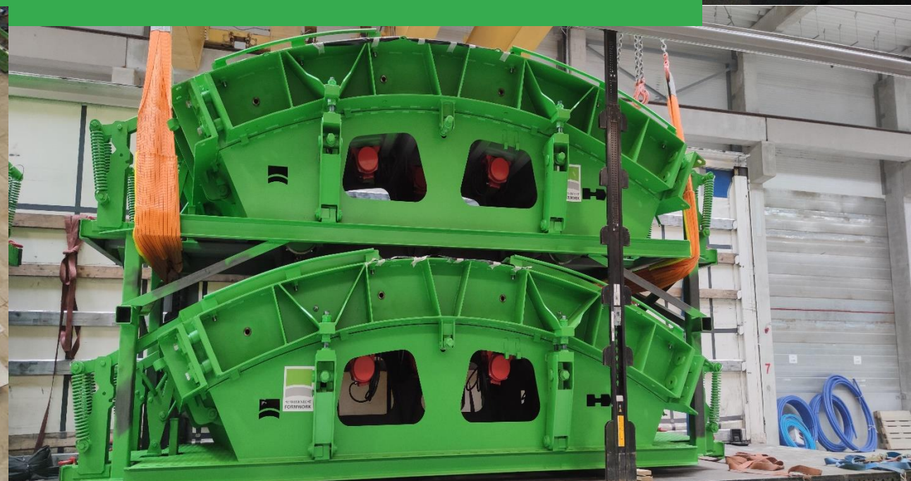
Nowoczesna hala i formy do produkcji elementów tunelowych
