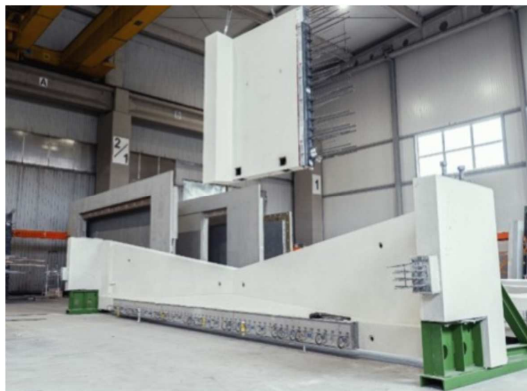
Element z białego betonu architektonicznego na osiedle Am Tacheles, Berlin
